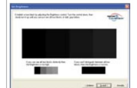
**06** Come è stato fatto per il livello di luminosità del bianco, sarà necessario impostare anche il livello di luminosità per il nero. Questa operazione è particolarmente importante per i monitor CRT, meno per il display LCD.
