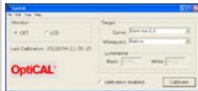
**01** Nella schermata principale del programma sarà possibile selezionare il tipo di display da calibrare, il valore di gamma e il punto di bianco. Nel caso abbiate già eseguito PreCAL selezionate "Native". Fatte le scelte in base al vostro monitor, cliccate su "Calibrate".
