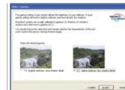
**03** Il passo successivo consiste nella scelta della Gamma, valore legato alla luminosità dei mezzi toni. Le scelte possibili sono essenzialmente 2: gamma 1.8 molto spesso valore standard per gli utenti Mac, e gamma 2.2, standard per i sistemi Windows.
