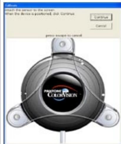
**04** A questo punto sarà necessario agganciare il sensore allo schermo e avviare il processo di analisi. Durante questa operazione, della durata di qualche minuto, verranno visualizzati colori e toni di grigio che verranno analizzati dal colorimetro.
