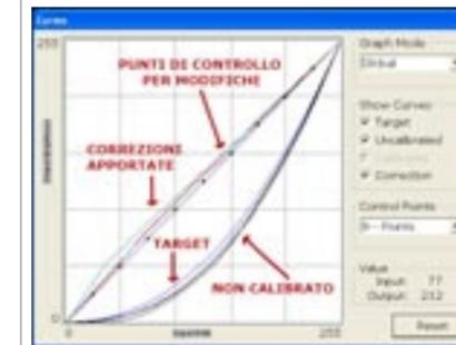
**03** Infine nell'immagine qui sopra è visualizzata la finestra Curve, attivabile selezionando Curve nel menu Tools. Il grafico mostra lo stato del monitor prima di essere calibrato, lo stato dopo la calibrazione, le correzioni apportate e, se è stata attivata la modalità di calibrazione precisa, si potranno apportare modifiche intervenendo su uno qualsiasi dei punti di controllo.
